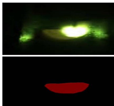
图 21 熔池原图和人工标注的熔池区域检测 [60]
